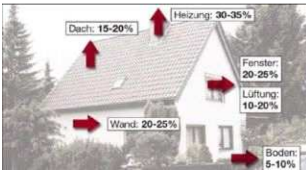
Wärmeverluste am Gebäude
